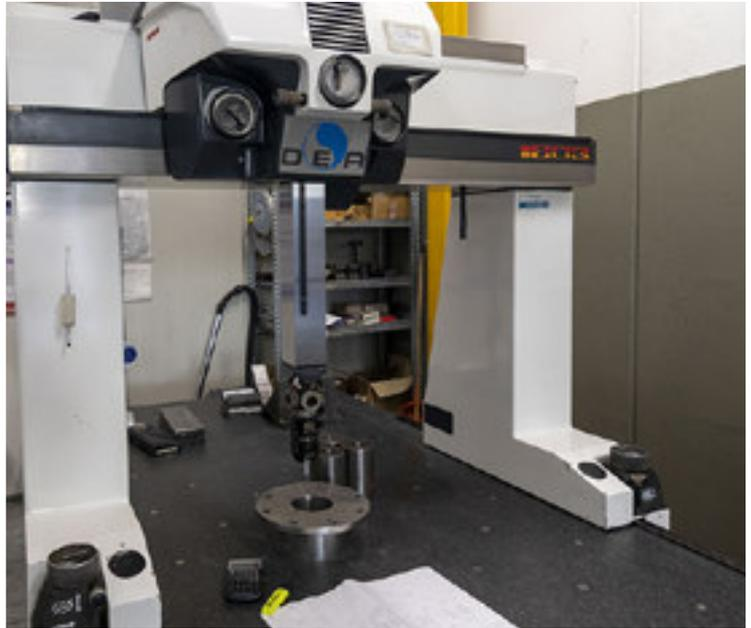
Macchina di misura DEA: tridimensionale, dimensioni misurabili asse X = 1.450 Y = 1.000 Z = 900. Precisione strumento  $10^{-7}$  m ( $10^{-4}$  mm).
